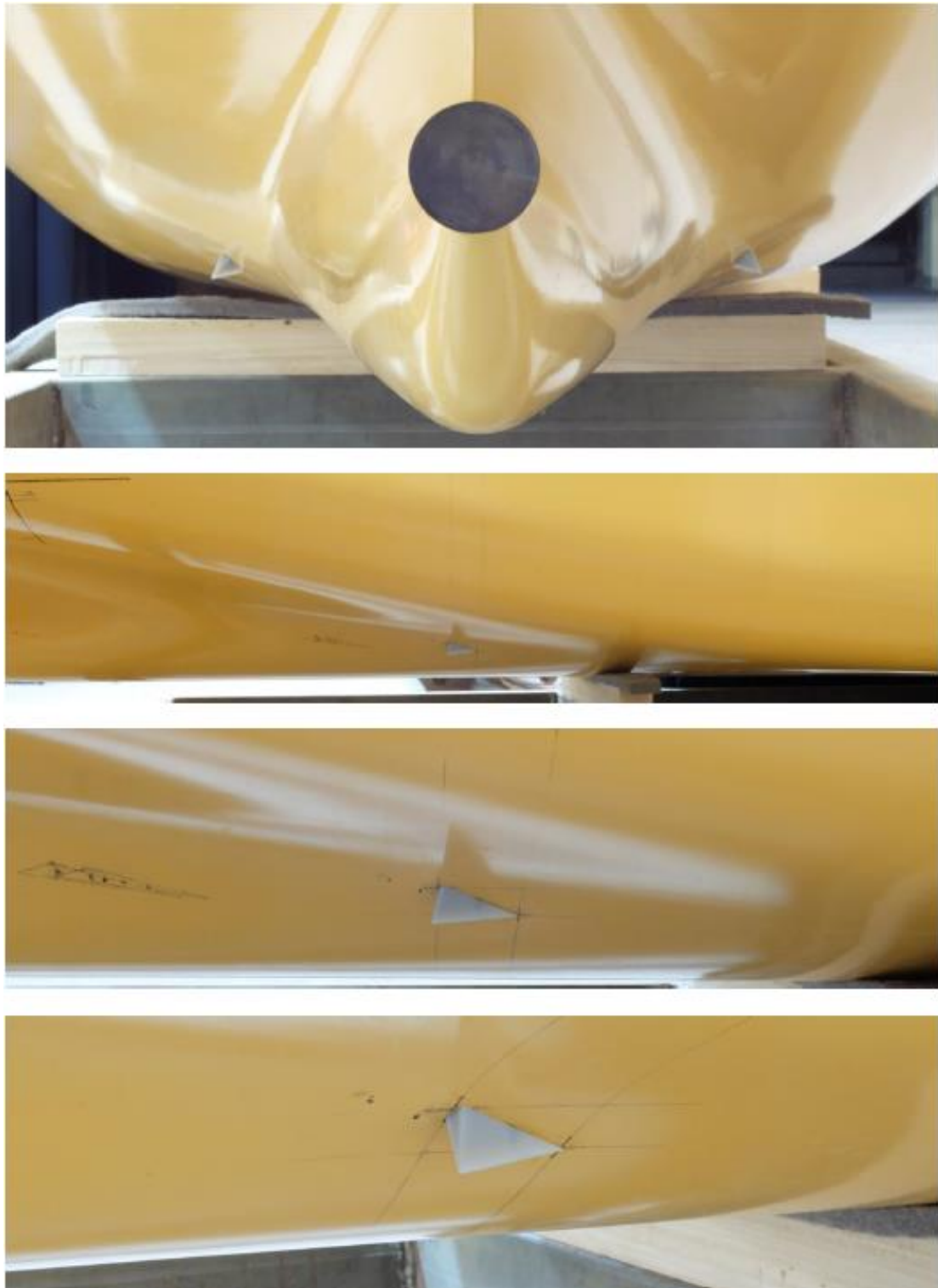
渦流產生器照片(來自船模試驗)
